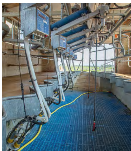
Une partie de la salle de traite Swing-Over avec 16 places avec vue sur la salle d'attente.
