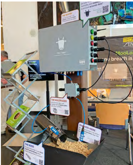
Sniffer, genannt MooLogger, der Firma Tecnozens, mit dem auch im Schweizer Methanprojekt CH 4 COW auf Brown-Swiss- und Holstein-Betrieben der Methanausstoß in der Ausatemluft von Kühen gemessen wird. Bild: Beat Bapst
