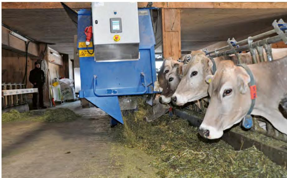
Exemple d'une mélangeuse sur rails
