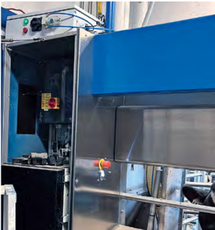
Sensore della ditta Tecnosens (in verde, in alto a sinistra sul robot di mungitura) che, attraverso un tubicino posto accanto al mangime premio, aspira l'alito esalato dall'animale.
