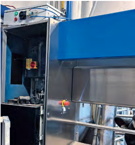
Sniffer de la société Tecnosens (boîte grise en haut à gauche sur le robot de traite). L'air respirable est aspiré à l'aide d'un tuyau fin près du fourrage.
