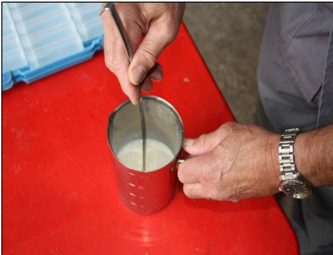
Vor der Probeentnahme ist die umgeschüttete Milch kräftig zu rühren. Das Gefäss muss gross genug sein, damit dies auch möglich ist.
