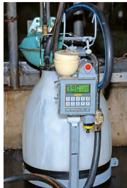
Des lactocorders sont utilisés pour déterminer les courbes de débit du lait.
